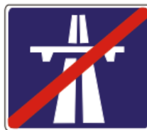
I.13 FIN DE AUTOPISTA
