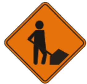
T.8 TRABAJOS EN LA BANQUINA
