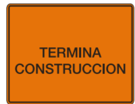
T.11 FIN DE LA CONSTRUCCIÓN
