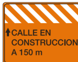
T.1 CALLE O CARRETERA EN CONSTRUCCIÓN O CERRADA
